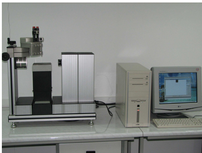
Rys. 1. Urządzenie UDPZ do pomiaru kątów zwilżania metodą osadzanej kropli Źródło: opracowanie własne.
