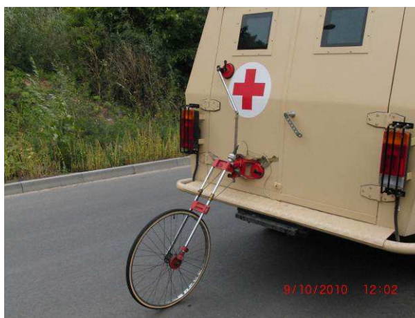
Rys.3. Piąte koło – pomiar drogi hamowania oraz prędkości początku hamowania
