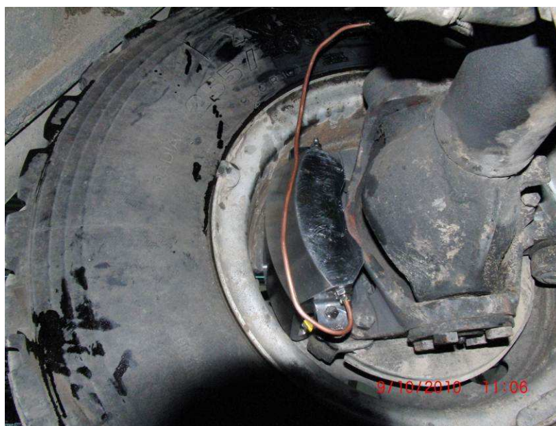
Rys. 4. Nowy hamulec trójrolkowy zamontowany na pojeździe
