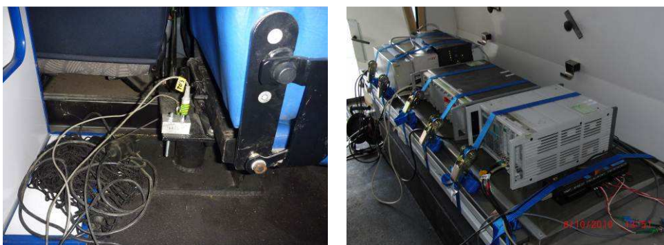
Rys.1. Czujniki i aparatura pomiarowa wewnątrz pojazdu.
