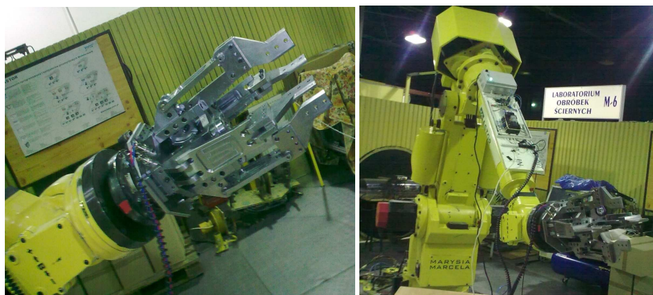
Rys. 11. Badania własności chwytaka na robocie Fanuc S420F „próbą pracy”
