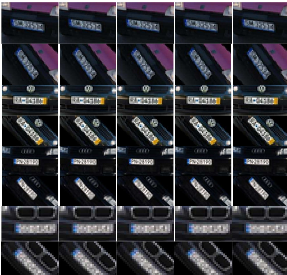
Rys.2. Przykładowe obrazy o obniżonej rozdzielczości wykorzystywane w algorytmie superrozdzielczości (połowa obrazów jest obrócona o kąt 45 stopni)
