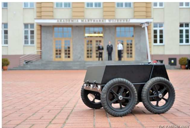
Rys.5. Prototypowy robot typu UGV z zamontowaną aparaturą pomiarową
