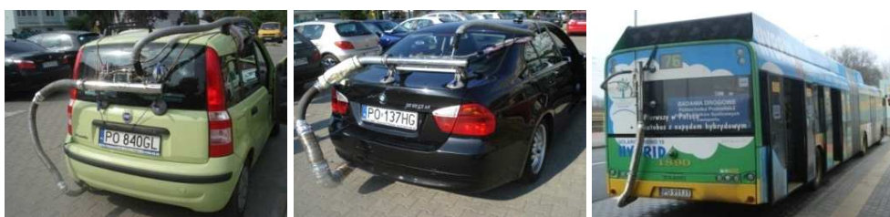
Rys. 1. Pojazdy wykorzystywane do badań z zamontowaną aparaturą pomiarową (widoczny przepływomierz spalin)
