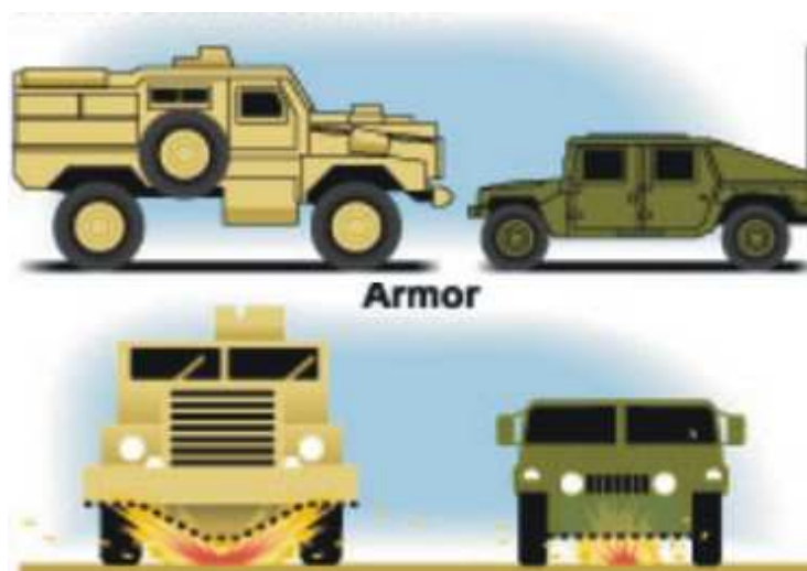
Rys. 3. Porównanie ukształtowania osłony balistycznej podwozia pojazdu CUGUAR oraz Humvee
