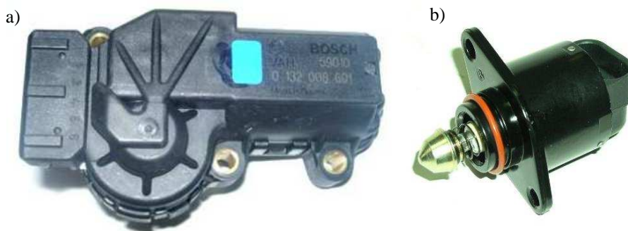
Rys.1. Silniki skokowe a) regulujący wtrysk silnika spalinowego, b) regulujący obroty biegu jałowego
