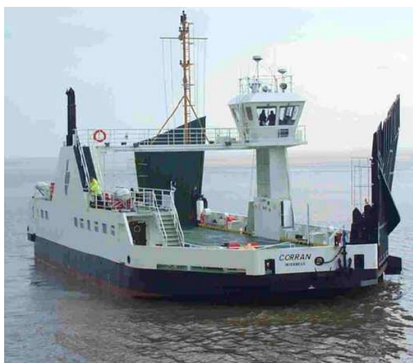
Rys.3. Prom Corran o podwójnej rufie (pędniki cykloidalne) pracujący w Szkocji [4]
