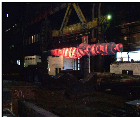
Rys. 5. Wykonanie odkuwek wałów korbowych jednolitych: a) sekwencje kucia korb, b) wał po odkuciu
