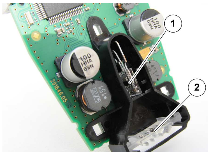
Rys. 4. Moduł prędkości zbliżenia. 1. Zespół diody laserowej, 2. Soczewka [3]
