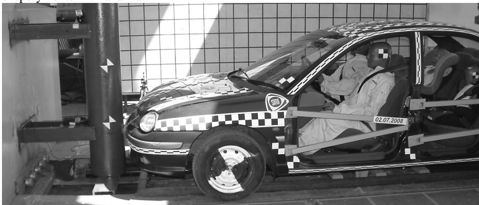
Rys. 1. Samochód Chrysler Neon przygotowany do próby zderzeniowej.
