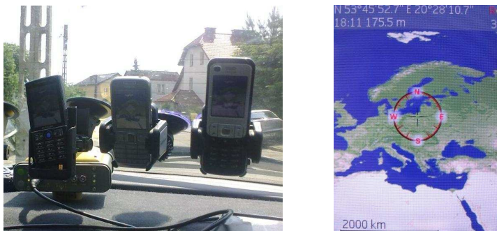
Rys. 4. Odbiorniki rejestrujące dane GPS oraz program TrekBuddy [1].
