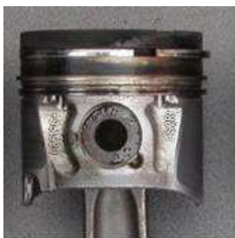
Rys. 2. Ocena wizualna stanu technicznego unieruchomienia pierścieni tłoka silnika DURATORQ TDCi ZASILANEGO OLEJEM NAPĘDOWYM Ekodiesel Ultra
