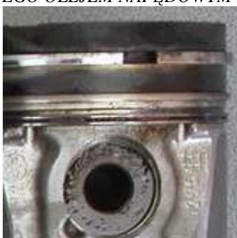
Rys.3. Ocena wizualna stanu technicznego unieruchomienia pierścieni tłoka silnika DURATORQ TDCi zasilanego biopaliwem B10 po przebiegu eksploatacyjnym 80 tys. km
