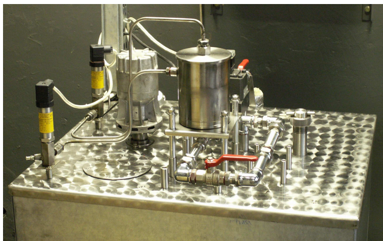
Rys.1. Widok ogólny stanowiska do badania filtrów paliwowych i olejowych silników spalinowych
