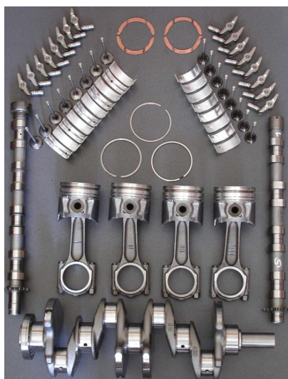
Rys.4. Pakiet elementów roboczych silnika o ZS objętych pomiarami mikrometrycznymi przed i po przebiegu eksploatacyjnym 80 tys. km
