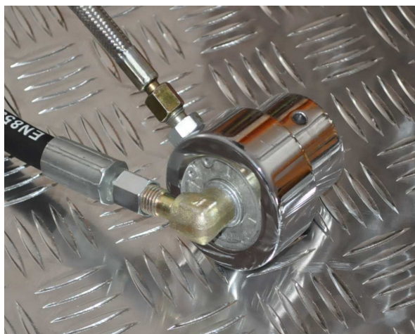
Rys. 2. Prototyp piasty pneumatycznej do badań eksperymentalnych
