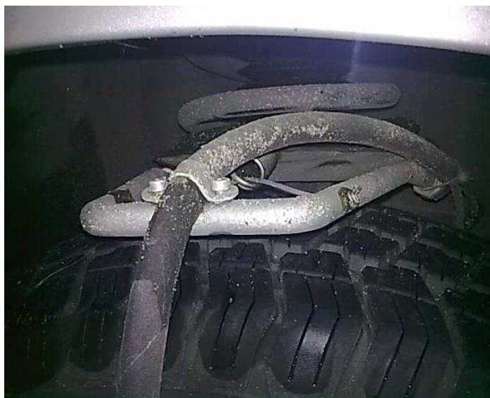
Rys. 4. Uchwyt mocujący przewód ciśnieniowy do zawieszenia platformy
