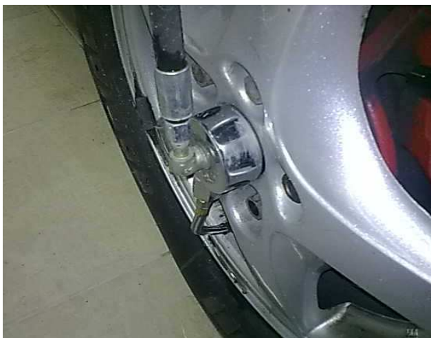
Rys. 3. Prototyp piasty pneumatycznej zamocowany w osi koła
