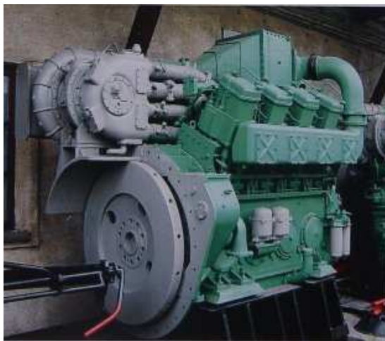
Rys.1 Widok silnika a8C22 od strony koła zamachowego.
