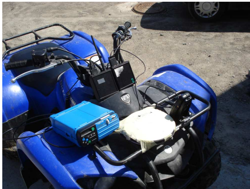
Rys. 1. Odbiornik geodezyjny Ashtech Z-Xtreme oraz antena Ashtech Geodetic 4, odbiornik nawigacyjny Thales MobileMapper z anteną, dwa moduły komunikacyjne GSM/IGTS-R zamontowane na pojeździe ATV YAMAHA GRIZZLY
