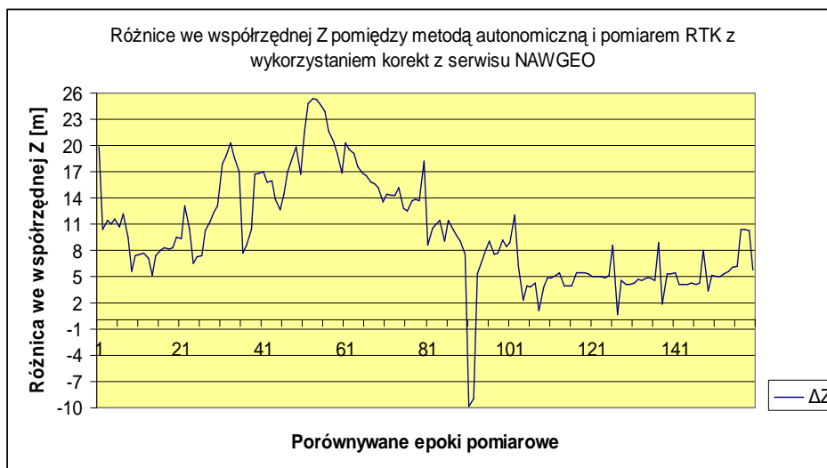
Rys. 9. Różnice we współrzędnej Z pomiędzy metodą autonomiczną i pomiarem RTK z wykorzystaniem korekt różnicowych z systemu ASG–EUPOS (odbiornik Thales X-Xtreme)
