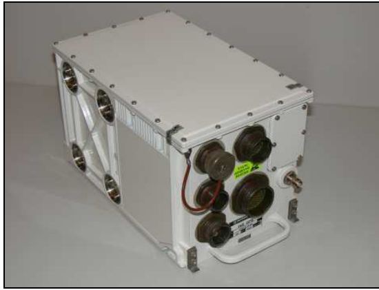
Rys. 1. Widok złącza zasilania i konektorów sygnałowych centrali EGI-3000
