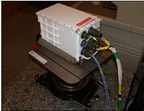
Rys. 21. Widok centrali nawigacji inercyjnej EGI-3000 na stole przechylnym KPA-5
