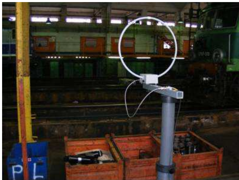
Rys.3. Aktywna antena pętlowa typu EMCO 6502 podczas pomiarów na hali lokomotywowni
