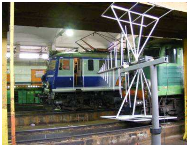
Rys.4. Aktywna bikoniczno-logarytmiczna typu EMCO 3141 podczas pomiarów na hali lokomotywowni
