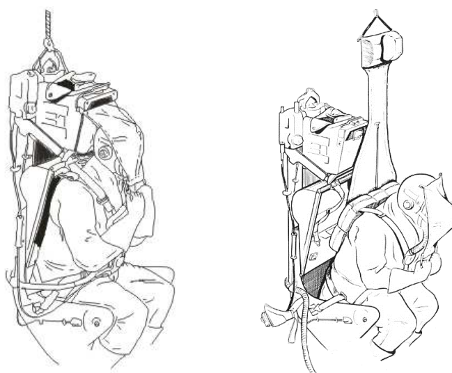
Rys.4. Mechanizm zwalnający fotela Mk.2 [1]
