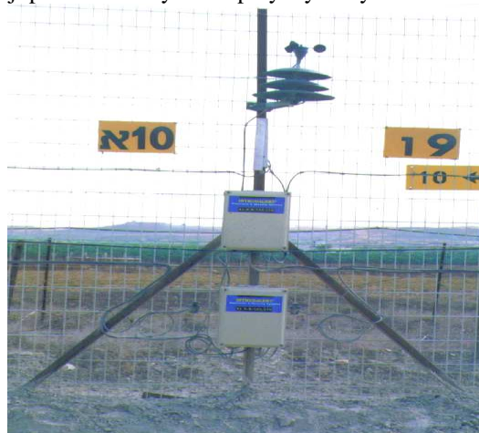
Rys.5 Układ korekcji parametrów systemu przy wykorzystaniu własnego systemu meteorologicznego
