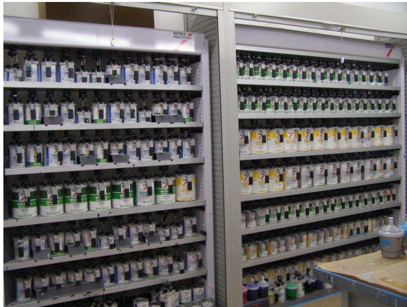
Rys.2. Szafa z mieszalnikami lakierów
