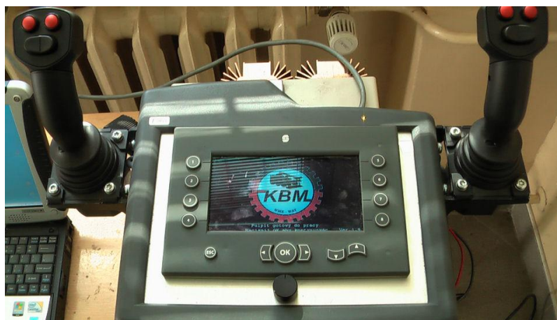
Rys.2. Widok pulpitu zdalnego sterowania robotem wsparcia inżynierskiego
