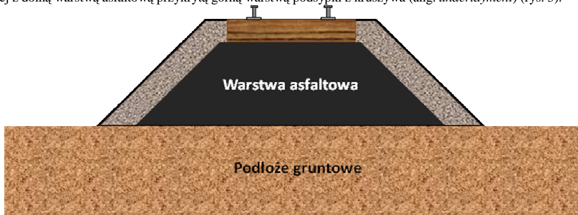
Rys. 2. Konstrukcja torowiska z pełną warstwą asfaltową
