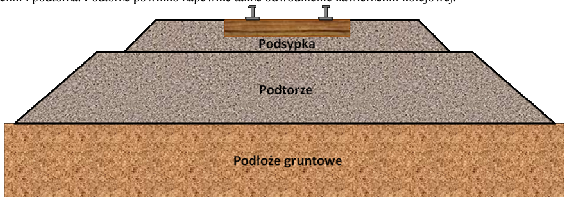
Rys. 1. Typowa konstrukcja nawierzchni i podtorza kolejowego
