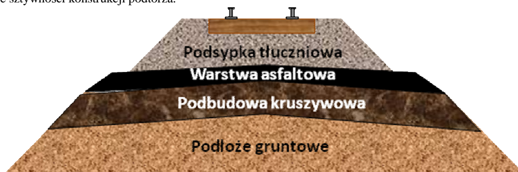
Rys. 4. Konstrukcja torowiska pierwszej Kolei Dużych Prędkości Shinkansen, Japonia
