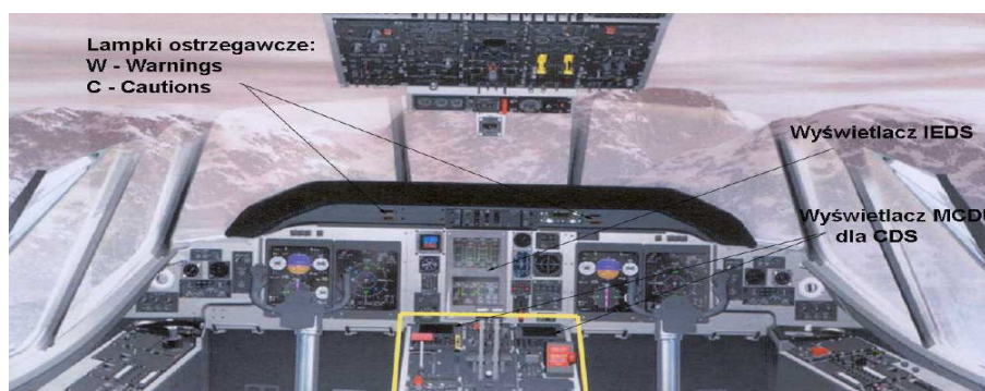
Rys.1. Widok kabiny z wyświetlaczami systemów IEDS i CDS oraz lampkami ostrzegawczymi
