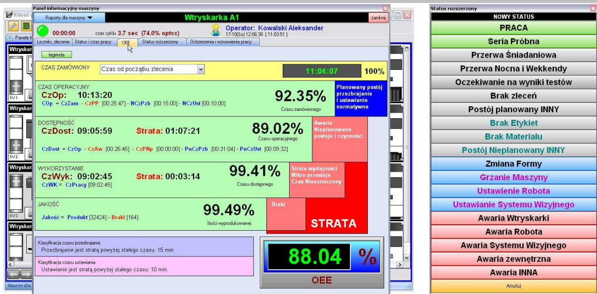
Rys. 5. Raport generowany przez program Golem a) oraz rozszerzona lista stanów maszyny b) 8
