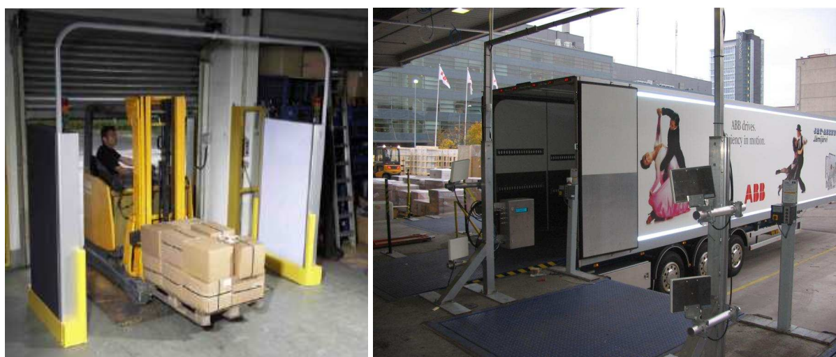
Rys. 7. Przykład wykorzystania technologii RFID w transporcie do identyfikacji ładunku 14
