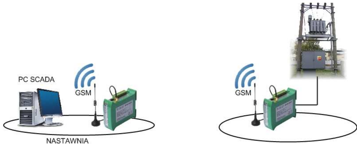
Rys. 4. Przykład wykorzystania komputera przemysłowego NPE 9201-GPRS do monitorowania pracy sieci energetycznej 11
