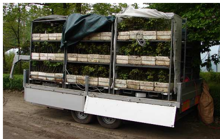
Rys. 8. Naczepa PIMR-N1-O2, do każdego okrytego oponczą kontenera załadowano 12 sztuk styropianowych kaset z sadzonkami dębu
