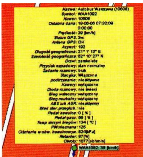
Rys. 5. Przykład transmitowanych danych z pojazdu a) oraz obrazu z kamer umieszczonych w pojeździe b) 3,7
