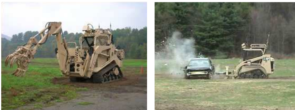
Rys.4. Inżynieryjny robot wsparcia RC-50 Robotic Platform – masa 3450 kg, moc 42 kW, uciąg 23 kN, obciążenie wywracające 1360 kg, udźwąg 680 kg, prędkość maksymalna 14,5 km/h – maszyna bazowa Cat 247B MTL
