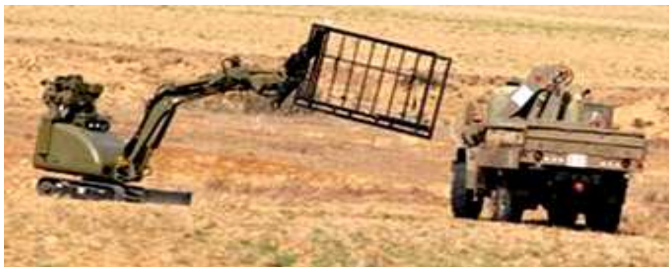
Rys.5. Izraelski Scorpion EOD Robotic Platform – masa ok. 3300 kg, moc 30 kW, udźwig na maksymalnym wysięgu (4,5 m) ok. 500 kg, na minimalnym wysięgu ok. 1800 kg, siła uciągu ok. 20 kN, prędkość maksymalna 5,1 km/h
