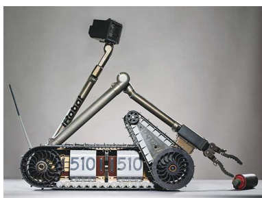
Rys.2. PackBot przy masie 18 kg rozwija prędkość 8 km/h, jest w stanie pokonać schody i krawężniki oraz podejmować ładunki o masie do 2,5 kg – cena wersji podstawowej ok. 100 tys. USD – w eksploatacji ok. 2500 szt.
