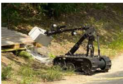
Rys.3. Talon przy masie ok. 50 kg rozwija prędkość 8 km/h i dzięki manipulatorowi może podejmować przedmioty o masie do 10 kg (nowy model 30 kg) - cena zależności od wyposażenia od 80-150 tys. USD – w eksploatacji ok. 2500 szt.
