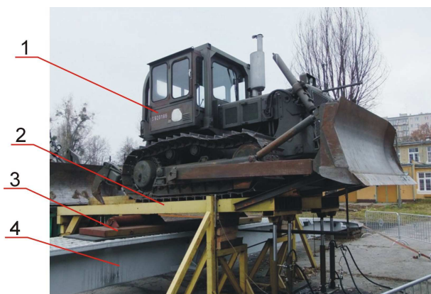
Rys.6. Widok ogólny stanowiska badawczego podczas przeprowadzania badań: 1 – pojazd obciążający (spycharka SG 15), 2 – pomost obciążający, 3 – płyta przekazująca obciążenie, 4 – przęsło (koleina mostu) BLG-60M2 (BLG67-M2)
