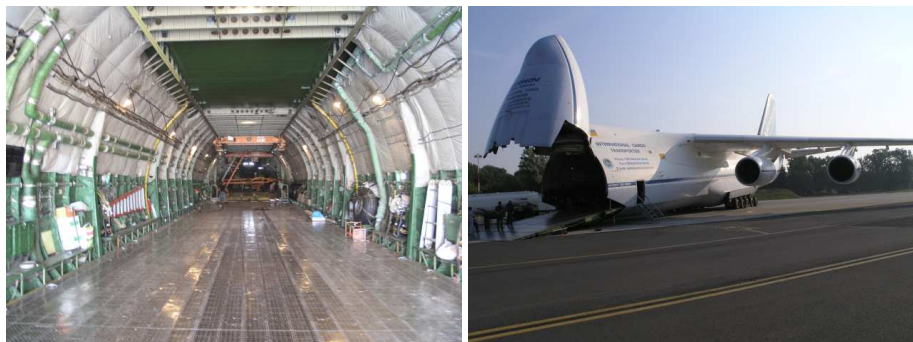
Rys.6. Przestrzeń ładunkowa AN 124 Rusłan Rys.7. Sposób rozładunku AN 124 Rusłan (fot. Jarosław Piekarski WITPIS)
