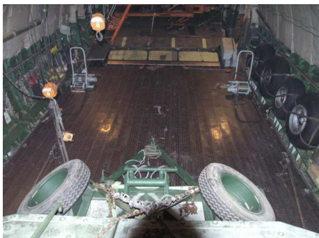
Rys.9. Sposób mocowania przyczepy (fot. Jarosław Piekarski WITPIS)
