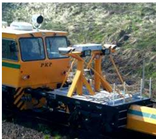
Rys.1. Pojazd UPS-80 do pomiaru skrajni (fot. www.graw.com )
