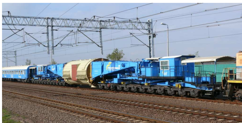
Rys.3. Pociąg z ładunkiem na wagonie NORCA24
