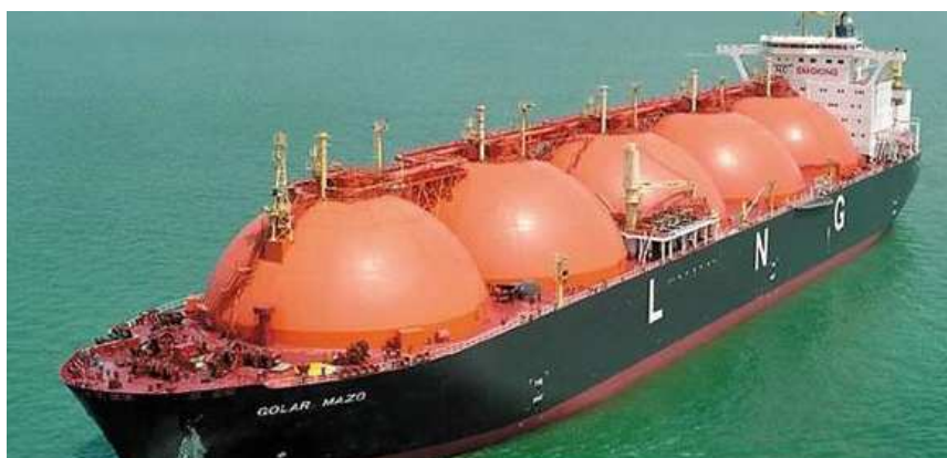
Rys.4. Metanowiec z zamontowaną instalacją regazyfikacji pełniący rolę pływającego terminalu LNG.
