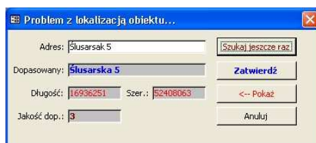
Rys.4. Interakcja z użytkownikiem po napotkaniu błędu w operacji geokodowania
