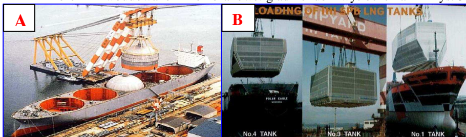
Rys. 3. Montaż zbiorników kulistych LNG – Moss-Rozenberg (A), montaż zbiorników membranowych LNG - Technigaz
