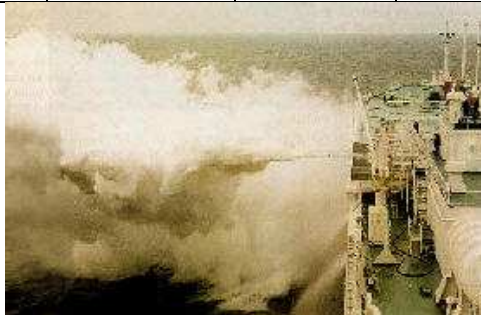
Rys.5. Awaria systemu i wyciek LNG
