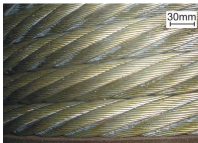
Rys. 2. Zwój liny przed założeniem do urządzenia wyciągowego
