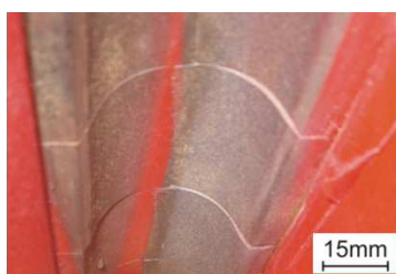
Rys. 3. Rowek koła linowego z wkładkami polimerowymi
