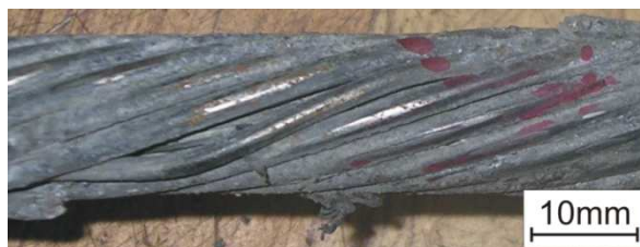
Rys. 6. Jedna ze splotek badanej liny. Pęknięty drut warstwy zewnętrznej. Drut warstwy wewnętrznej odkształcony
