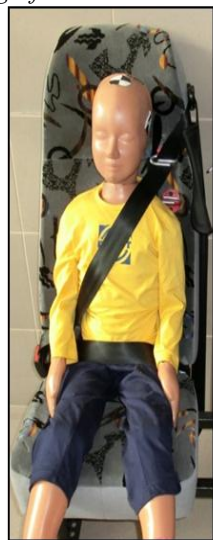
Rys. 12. Fotel wyposażony w 3-punktowy pas bezpieczeństwa i mechanizm przeznaczony do dostosowania przebiegu taśm pasów bezpieczeństwa do wzrostu dziecka (na fotografii manekin dziecka 6-letniego o masie 22 kg)
