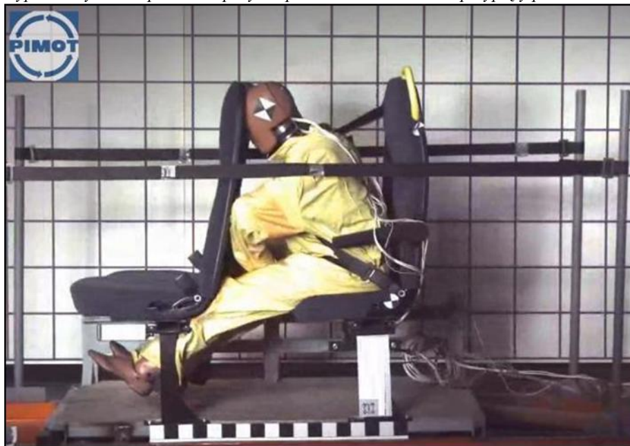
Rys. 8. Test foteli wyposażonych w 3-punktowe pasy bezpieczeństwa – manekin przypięty pasami
