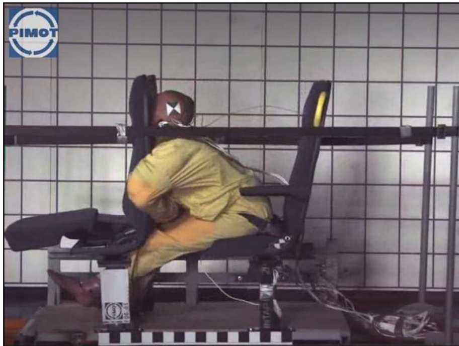
Rys. 7. Test foteli wyposażonych w 2-punktowe pasy bezpieczeństwa – manekin przypięty pasami
