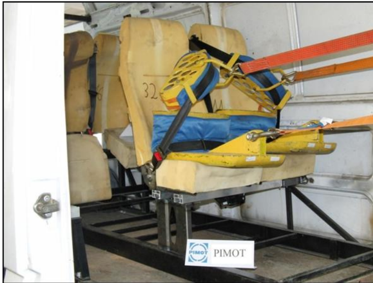
Rys. 4. Badanie foteli zgodnie z wymaganiami Regulaminu EKG ONZ nr 14
