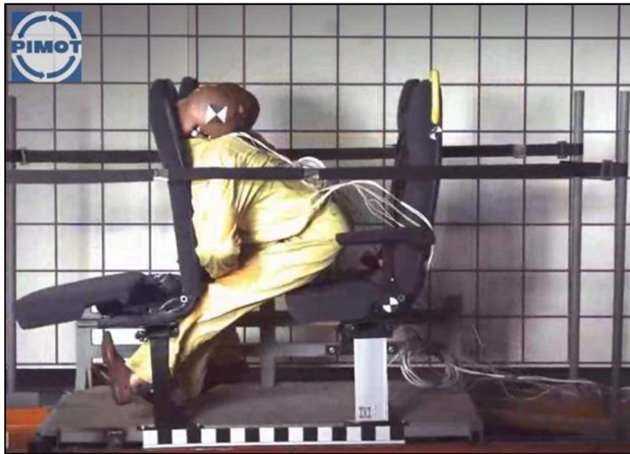
Rys. 9. Test foteli, które mogą być wyposażone w 2-punktowe i 3-punktowe pasy bezpieczeństwa – manekin nie przypięty pasami
