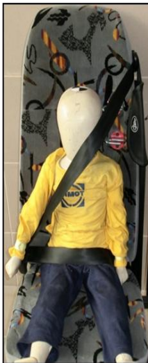
Rys. 10. Przebieg 3-punktowych pasów bezpieczeństwa względem ciała dziecka (na fotografii manekin dziecka 3-letniego o masie 15 kg)
