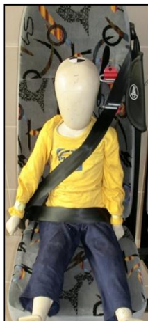
Rys. 11. Fotel wyposażony w 3-punktowy pas bezpieczeństwa i mechanizm przeznaczony do dostosowania przebiegu taśm pasów bezpieczeństwa do wzrostu dziecka (na fotografii manekin dziecka 3-letniego o masie 15 kg)
