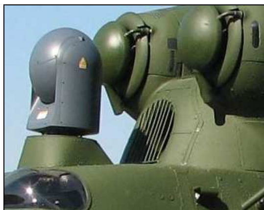
Rys. 11. Widok głowicy TOPLITE zabudowanej na śmigłowcu W-3PL GŁUSZEC
