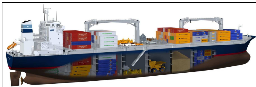
Rys.3. Rysunek poglądowy masowca uniwersalnego – z różnorodnym ładunkiem w ładowniach i na pokładzie
