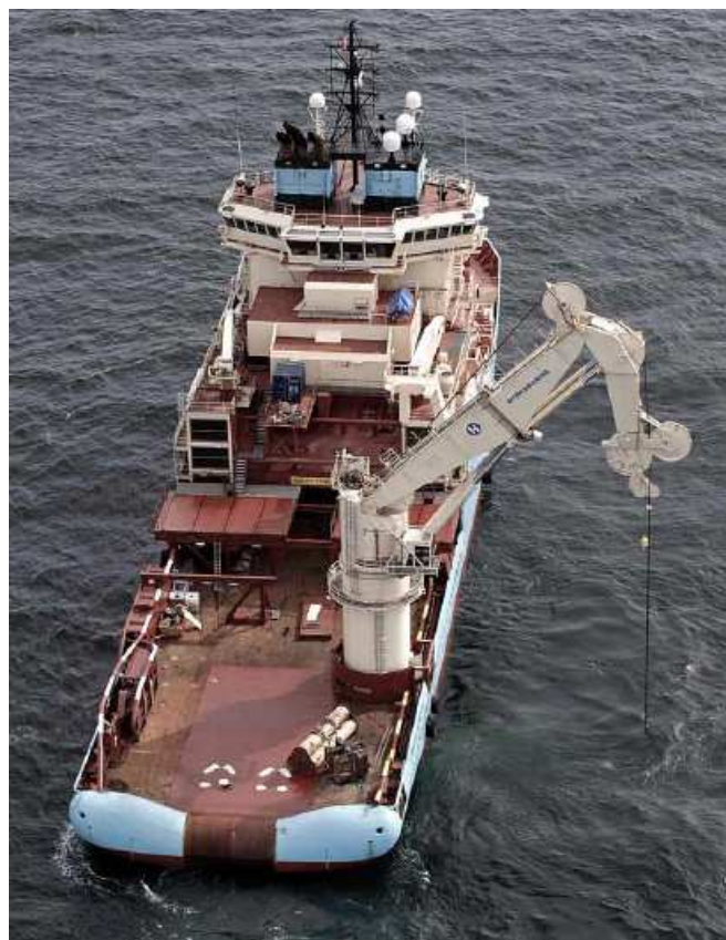
Rys. 10. Ms. Maersk Achiever - jednostka wspomaganie offshorowego – A-type craned offshore support vessel.
