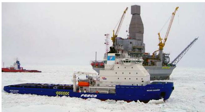
Rys. 8. Jednostka zaopatrzenia i zabezpieczenia platform z możliwością łamania pokrywy lodowej – ms. Fesco Sakhalin.
