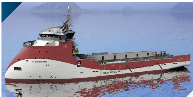
Rys. 12. Jednostka wielofunkcyjna zaopatrzenia platform – projekt PX119.
