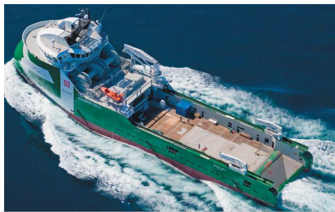
Rys. 7. Bourbon Orca – jednostka do rozwożenia kotwic i zaopatrzenia platform – projekt AX104. Źródło: www.ulsteingroup.com .
