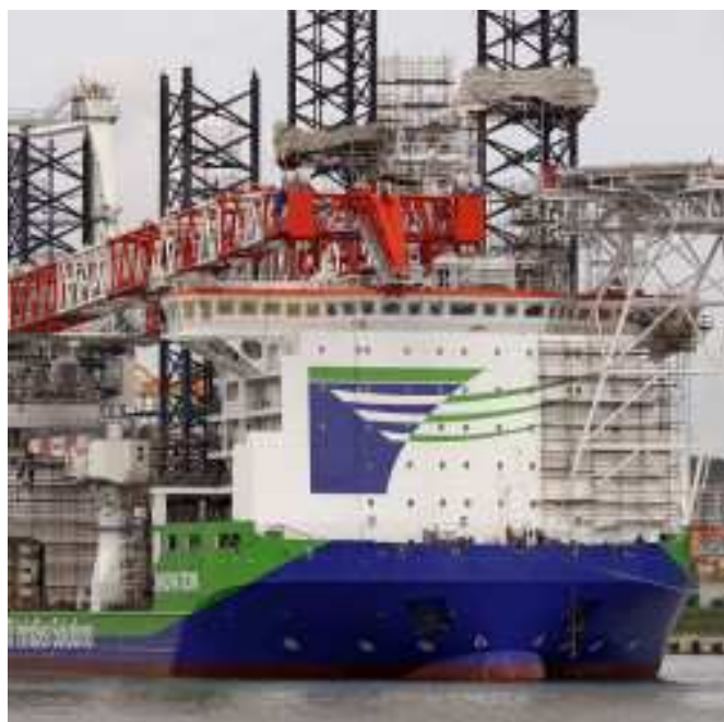
Rys.1. Ms Innovation – statek typu heavy lift jack up vessel do montażu elektrowni wiatrowych na morzu.
