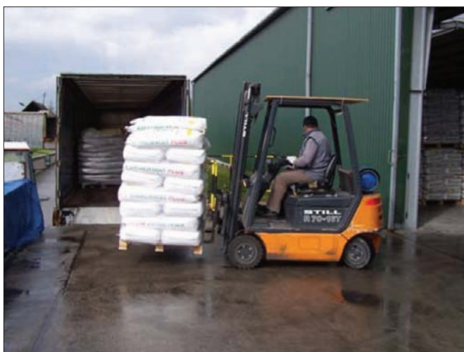
Fot. 2. Załadunek nasion wózkami widłowymi na środek transportu przy wykorzystaniu rampy załadowniczej. Źródło: DANKO Hodowla Roślin Sp. z o.o.
